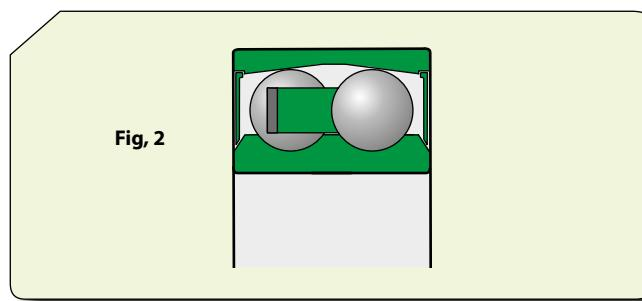
Le guarnizioni incorporate sono in gomma acrilonitrile-butadiene (NBR), materiale resistente all'olio e all'usura, e vengono rinforzate con un lamierino in acciaio.
