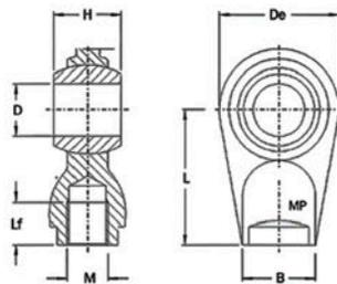
Rótulas con terminación redonda para cilindros hidráulicos (para soldar o con rosca interior)
