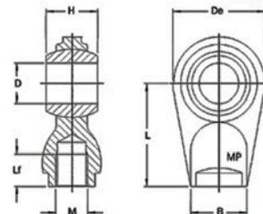
Rótulas con terminación redonda para cilindros hidráulicos (para soldar o con rosca interior)
